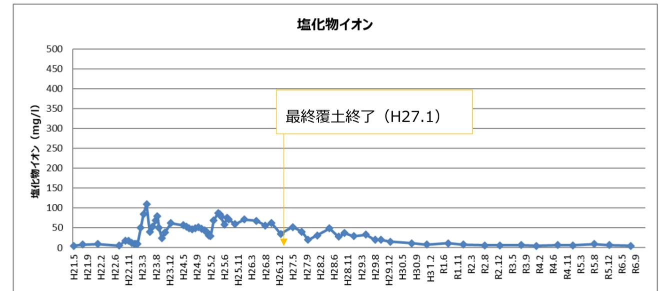
「地下水集排水管モニタリング人孔」の環境モニタリング結果 (地図●④)
